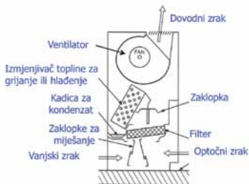
Slika 4. Shematski prikaz i presjek ventilokonvektora stojeće izvedbe
